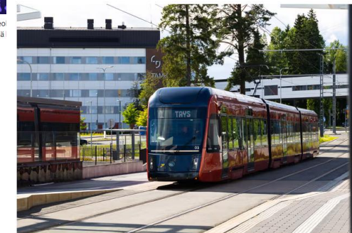
Tällä hetkellä Tampereen ratikat ovat 37-metrisiä. Tulevaisuudessa osassa Tampereen ratikoista on kolmen sijasta neljä moduulia ja pituutta 47 metriä. Arkistokuva. Kuva: Senni Nieminen / Yle
